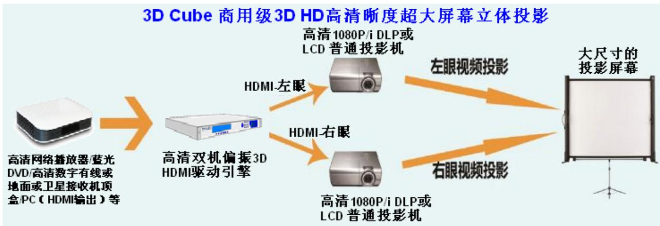
因而，以 3D Cube 高清双机偏振 3D HDMI 驱动引擎为中心，配合两台同一型号的、成本低廉的高清 1080P/i DLP 或 LCD 普通被动式 2D 投影机（带圆或线偏振片）和一块大尺寸的金属屏幕，以及多个被动式 3D 眼镜，将组成不晕、不闪的“健康”3D Cube 商用级 3D HD 高清晰度超大屏幕立体投影解决系统；其整个 3D HD 高清晰度超大屏幕立体投影系统所显示的 3D 立体视频投影的画面清晰、细腻、逼真而稳定，饱和度好、锐度高、色彩还原好，具有场景与物体的立体景深的 3D 的真实感，尤其可使前景对象（投影主体）“延伸”至观众的眼前，感觉前景对象（投影主体）真的“跑”出了投影屏幕，且所投影出的立体影像也凸显出前景对象（投影主体）与周围环境之间的落差感和层次感，让所有观众有更加身临其境的真实和“震撼”的感觉，且无频闪（不晕、不闪），即无头晕和眼花等的不适感。
