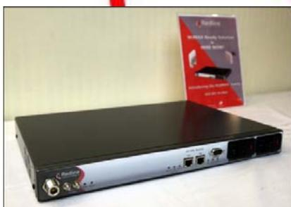
左图即为 Airspan 所推出的桌面 WiMAX“连接点”EasyST。如果需要额外的射程，可以插入电缆，用吸盘可吸到窗户上。
