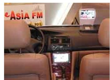
小车类的移动载体，包括出租车、正在迅速增长的私人小轿车(私家车)，以及部分政府机关、社会团体和企事业单位的领导用商务车。其相应地面移动车载数字电视接收机顶盒，与公交类车载式的相比，更注重外观，小巧而典雅，多与中、小尺寸的吊挂式或遮阳板式或可折叠式的 **TFT-LCD** 液晶显示器配合；除可采用车外安装的尺寸长的杆状天线外，还可采用安装在车前后窗体上的 1 或 2 套贴片式小型天线；在小车类的移动载体上，相应地面移动车载数字电视接收终端，尤其显示器的安装位
