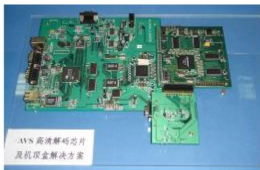
GP0011 是宏景微电子公司设计的一款基于国内自主标准 AVS 的高清解码 SoC 芯片。可以应用在数字电视、高清电视、IPTV、高清激光视盘机等产品领域并推出相关解决方案。目前该芯片的设计已进入量产阶段，预计今年年底量产成功并推出样片。芯片的设
